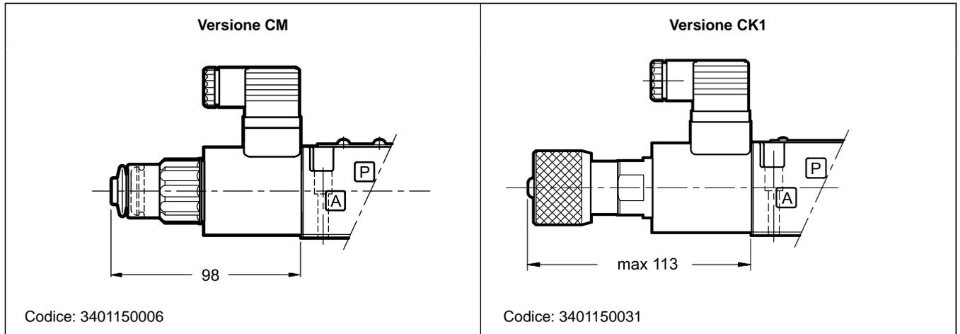
Per QDE5 è disponibile il comando manuale di emergenza a manopola **CK**: quando il grano è avvitato e la testa è a filo della manopola, avvitare la manopola fino in battuta: in questa posizione il comando non risulta impegnato. A comando regolato si può serrare il grano per evitare che la manopola si allenti.
