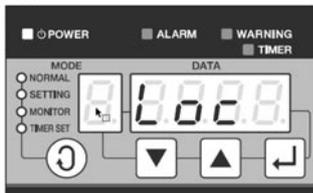
I refrigeratori AKW\* sono configurabili attraverso il display, dal quale è sempre possibile impostare e monitorare parametri e allarmi. Solo i refrigeratori AKW\* con porta di comunicazione (opzione J nel codice di identificazione) consentono il controllo remoto dal pannello di controllo della macchina principale.
