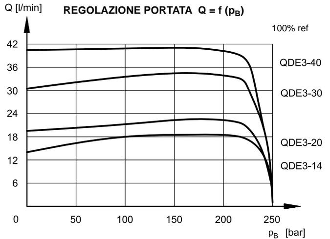
Curve tipiche di regolazione portata A → B in funzione del segnale di riferimento per le taglie 14 - 20 - 30 - 40 l/min.
