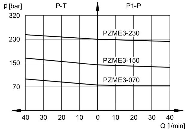
Die Kennlinien wurden mit einem Eingangsdruck ermittelt, der 50 bar höher als der Nenndruck liegt.
