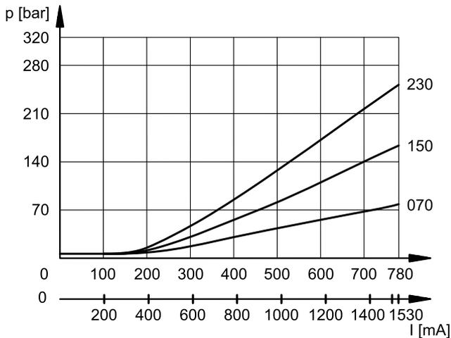
Die Kennlinien wurden mit geschlossenen Arbeitsanschlüssen ermittelt (ohne Strömung).
