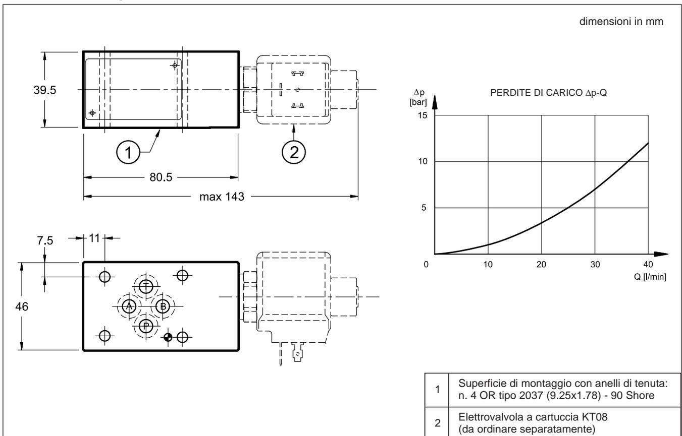
**20.4 - Dimensioni di ingombro e di installazione KTM3-D, KTM3-RD e KTM3-SB**
