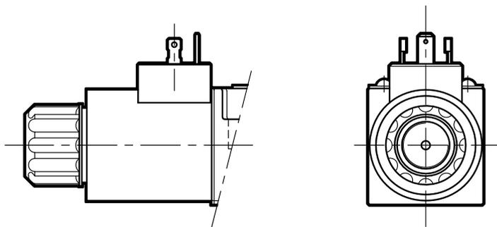
Anschluss für Würfelstecker M12x1 5-polig
