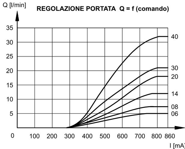
Curve tipiche di regolazione portata A → B in funzione della corrente al solenoide (versione D24, corrente max 860 mA e PWM 100 Hz)
