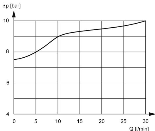
Druckverluste mit Durchfluss A → T durch das Rückschlagventil.
